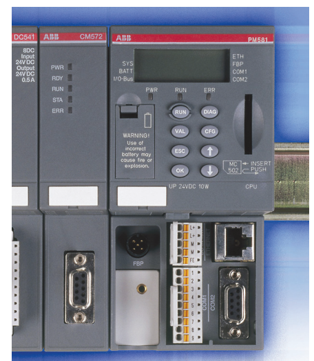
Bild 2. Die SPS AC500, auf der alle Programme abgespeichert sind, die für das Prüfen im Prüffeld relevant sind, überwacht die Peripherie
